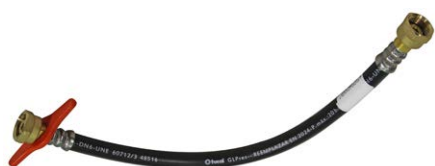
Lira para colector GLP L=70 cm. Conexión 21,8 izq - 21,8 izq Lira Trenzada Mgas L=72 Cm. 21,8x21,8
