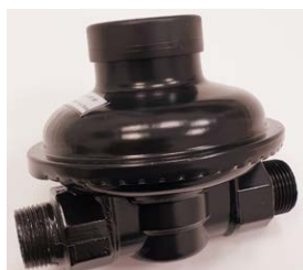
Regulador abonado recto 3/4" con mínima PS: 100 mbar Regulador para su montaje en contador y/o entrada vivienda. Presión de entrada 400 mbar. Caudal 6 Nm3/h. Seguridad de mínima de rearme automatico.
