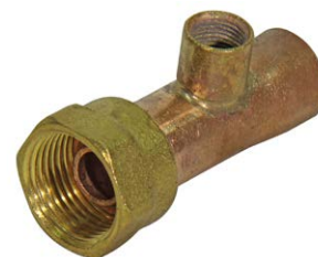
Racor dos piezas 20x1,5 soldar Cu Ø15mm con toma roscada Hembra 1/8"
