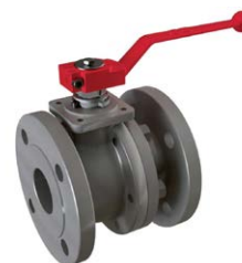
Válvula de bola para gas PN16 DN32 Válvula para gas, cuerpo acero DIN GS-C25 1,0619, cierre esfera inox AISI-316, bridas DN-32 DIN-2501/EN-1092, longitud: 130mm y presión máxima de trabajo 16 bar según EN-13774
