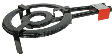
Paellero circular 2 fuegos diam.41 mod B 400P g.l.p. y termopar con conex. m1/2" potencia 11,2kw
