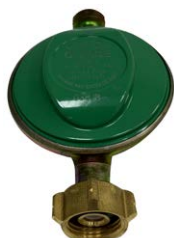
Regulador CLESSE 425 NF 28 mbar conexiones Entrada Tuerca Loca 21,8 salida M 20x150
