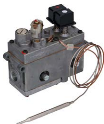
Valvula Minisit-Calentador Simple Válvula MINISIT calentador, conexión entrada 1/2" x salida 3/4", hembras BSP, temperatura de regulación 30 - 100 °C y longitud del capilar 1050 mm (710.251).
