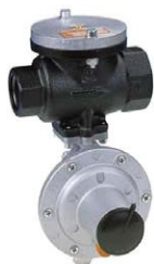
Válvula seguridad externa VIS de 1" máx. de 280 a 450 mbar mín. de 60 a 240 mbar P.FIORENTINI DILOCK-507-LA/MP
