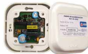
Fuente de alimentación para Detector Mod. D-203
