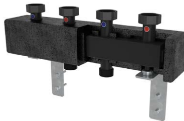
Colector/separador de acero 1 1/2" 3 vias DN 32 c/aislamiento caudal max. 3.000 l/h 125 mm entre ejes
