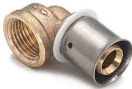
Codo terminal Ø25x2,5 - 1" - Compatibles con las principales mordazas RF, H, U y TH. - Codo terminal 25 x 2,5 - 1" PRESS-FITTING.
