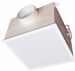
Unidad terminal de aire con entrada lateral y toma D.O.P. para filtro absoluto MUNDOFAN MU-HEPABOX 6/6 640x640x430mm
