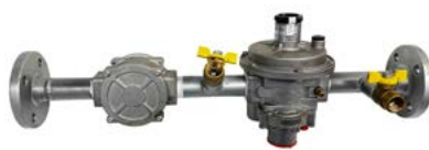
Línea F-R Modelo Asturias Pe: 0,4 ÷ 5 Bar Ps: 150 Mbar Q:100 Nm 3 /H. E/S Dn25 Pn16. L: 600 Mm
