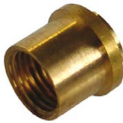
Racor portamanómetro de latón rosca Hembra 1/4" para tuercas de 20x1,5 y 21,8 izquierda
