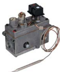
Valvula Minisit-Calentador Simple Válvula MINISIT calentador, conexión entrada 1/2" x salida 1/2", hembras BSP, temperatura de regulación 30 - 100 °C y longitud del capilar 1050 mm (710.251).
