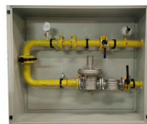
Armario MPA para G100 en FIG I de pistones Ps: 150 mbar Q: 160 Nm 3 /h con máx. y min. MERCAGAS A100NGAP
