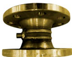
Carrete de doble brida entrada DN100 con toma de 1/8" para contador G100 membrana MERCAGAS
