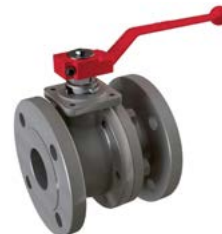
Válvula de bola para gas PN16 DN32 Válvula para gas, cuerpo acero DIN GS-C25 1,0619, cierre esfera inox AISI-316, bridas DN-32 DIN-2501/EN-1092, longitud: 130mm y presión máxima de trabajo 16 bar según EN-13774
