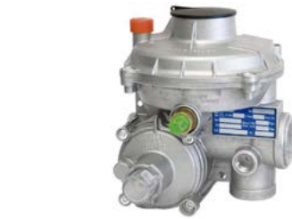
Regulador 50 Nm3/h. Conexiones roscadas H 1/2" x H 1" Ps: 400, 500 y 600 mbar solo máxima P. FIORENTINI FE-50TR
