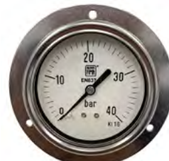
Manómetro diámetro 63 mm posterior con aro frontal rosca 1/4" 0-40 bar
