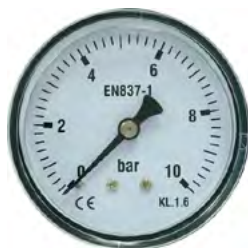
Manometro metalico diámetro 50 mm posterior rosca 1/8" 0-10 bar
