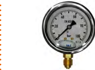
Manómetro glicerina MEI Ø63mm vertical 1/4" 0 a 100bar
