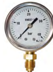
Manometro con glicerina diámetro 50 mm vertical rosca 1/4" 0-40 bar
