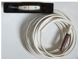
Termometro rectangular con bulbo y capilar IMIT Escala -40 a +40°C . Capilar 1 metro ,caja de 65x14mm
