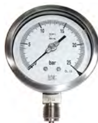
Manometro de acero inoxidable diámetro 100 mm vertical rosca 1/2" 0-25 bar
