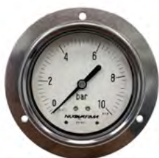
Manómetro diámetro 63 mm posterior con aro frontal rosca 1/4" 0-10 bar
