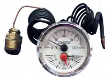
TERMOMANOMETRO CON CAPILAR PARA PANEL Ø52MM 0 ÷ 120°C/0 ÷ 6KG/ CM2 1,5MTS.
