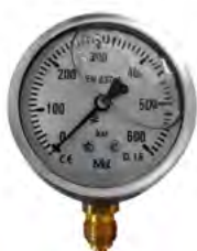
Manómetro glicerina MEI Ø63mm vertical 1/4" 0 a 600bar
