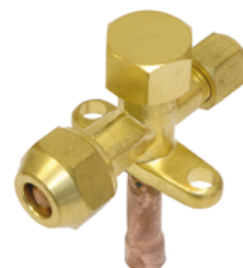
VALVULA SPLITS RR.603-04 CON OBUS DE 1/4 Y 1/4 SAE X 1/4 ODF
