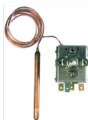
Termostato TR2 con bulbo y capilar IMIT Escala de 0 a 40 Capilar 0,5 metros . contacto conmutado .
