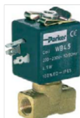
Válvula de solenoide PARKER VE179 AV , rosca 1/8" normalmente cerrada, cuerpo de latón, cierre vitón, presión de trabajo: 0-10 bar , temperatura máxima 140 °C. (incluye bobina 220 V)
