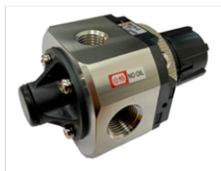
Reductora De Presion Acero Inoxidable Srh 4110-03 .Reg-0,5 A 7 Bars 3/8"
