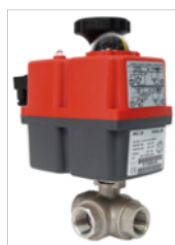
Válvula bola 3 vías inox paso T 1/4"H con actuador eléctrico J4C-S20 Válvula esfera tres vías paso L con paso reducido en acero inoxidable, con actuador eléctrico J4C multitensión de 24 a 240 VAC/VDC de funcionamiento a 3 puntos con finales de carrera.
