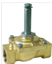
Cuerpo válvula de solenoide PARKER PM169 DN , rosca 1" normalmente abierta, cuerpo de latón, cierre NBR, presión de trabajo: 0,5-16 bar , temperatura máxima 90 °C.
