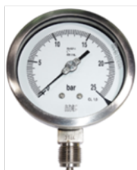
Manómetro de acero inoxidable diámetro 100 mm vertical rosca 1/2" 0-25 bar
