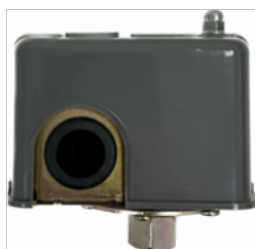
Presostato MUNDOCONTROL SK5N Escala de regulacion 0,8 a 4 Bar, conexión tuerca giratoria 1/4", ideal para grupos de presión de agua
