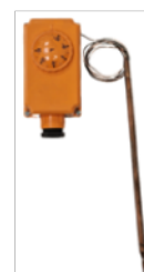
Termostato bulbo y capilar IMIT TC2 Escala -30 a +20°C, capilar 1 metro ,contacto conmutado
