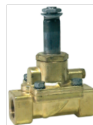
Cuerpo válvula de solenoide PARKER PM143 CN , rosca 3/4" normalmente abierta, cuerpo de latón, cierre NBR, presión de trabajo: 0,1-20 bar , temperatura máxima 90 °C.
