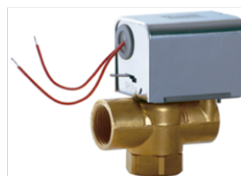
Válvula de zona IT DB-VZ2-20SA /SE Valvula 2 vías 3/4" motorizada a 230v/50hz ,accionamiento todo-nada tipo desviadora
