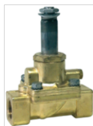
Cuerpo válvula de solenoide PARKER PM143 IN , rosca 3/8" normalmente abierta, cuerpo de latón, cierre NBR, presión de trabajo: 0,1-20 bar , temperatura máxima 90 °C.
