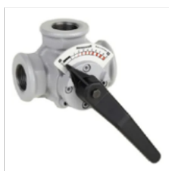
Válvula 3 Vías Rotativa 1" Kvs10 Máx.130°C Para Actuadores M6061a/ M6061l Honeywell Dr25gmla
