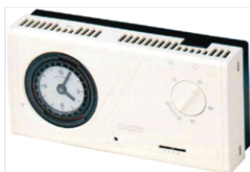
Cronotermostato analogico IMIT CHRONOMIT Escala de 10 a 30°C , programacion diario con reserva , regulacion horaria mediante caballetes plasticos
