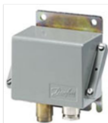
Presostato DANFOSS CAS 136 Escala 0 -10bar, conexión 1/4", contacto SPDT, IP67
