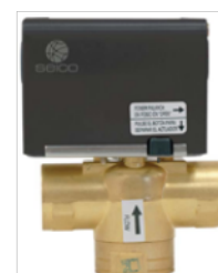
Valvula de de zona SEICO VZ3V-20 3 vías 3/4" retorno por muelle , Cuerpo en laton ,tipo desviadora alimentacion 230/50Hz
