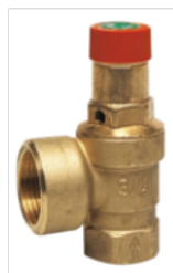
Valvula Seguridad 2,5bar Salida 2"-Entrada 1"1/4 120°C Honeywell Sm120-11/4a
