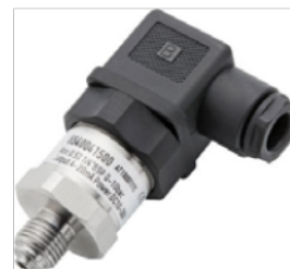
Transmisor de presión ITEC Escala-1 a 0 bar.rosca macho 1/4", salida 4 a 20mA, Alimentación 9 a 30VCC
