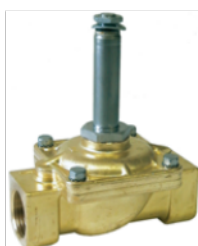
Cuerpo válvula de solenoide PARKER PM168 DN , rosca 1" normalmente cerrada, cuerpo de latón, cierre NBR, presión de trabajo: 0,5-16 bar , temperatura máxima 90 °C.
