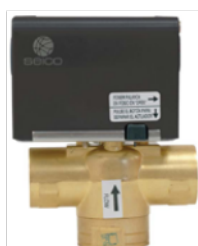
Valvula de de zona SEICO VZ2V-15 2 vías ,1/2" retorno por muelle , Cuerpo en laton ,tipo desviadora alimentacion 230/50Hz
