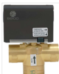
Valvula de de zona SEICO VZ3V25 3 vías ,1" retorno por muelle , Cuerpo en laton ,tipo desviadora alimentacion 230/50Hz
