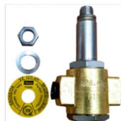
Válvula de solenoide PARKER PM 120.4IR , rosca 1/8" normalmente abierta, cuerpo de latón, cierre ruby, presión de trabajo: 0-30 bar , temperatura máxima 150 °C.
