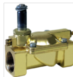
Cuerpo válvula de solenoide PARKER 7321BCN02 CMV 3/4", rosca 1" normalmente cerrada, cuerpo de latón, cierre NBR, presión de trabajo: 0,1-20 bar, temperatura máxima 90 °C, con mando de apertura manual y regulador de velocidad
