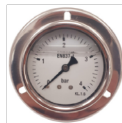
Manómetro con glicerina diámetro 100 mm posterior con aro frontal rosca 1/2" 0-4 bar
