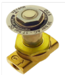
Válvula de solenoide PARKER PM 140 IR , rosca 1/8" normalmente cerrada, cuerpo de latón, cierre ruby, presión de trabajo: 0-30 bar , temperatura máxima 150 °C.
