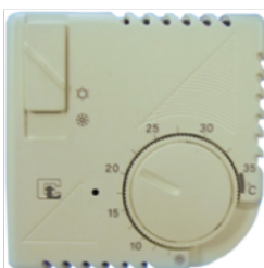
Termostato ambiente electronico CAMPINI TY180.2 Escala de 5 a 30°C.Interrupto on/off reduccion nocturna por señal externa,contacto conmutado
