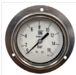
Manómetro de acero inoxidable diámetro 63 mm posterior con aro frontal rosca 1/4" 0-16 bar
