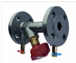
Valvula de equilibrado IMI-TA STAF SG Valvula de equilibrado, cuerpo en fundición nodular ,PN-25, extremos bridados DN32
