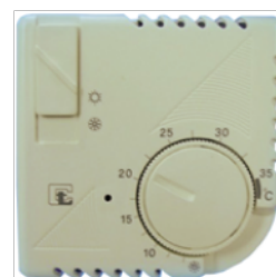
Termostato ambiente CAMPINI TY90B7 Escala de 5 a 30°C ,resistencia aceleradora,on/off interruptor invierno/verano .contacto no conmutado
