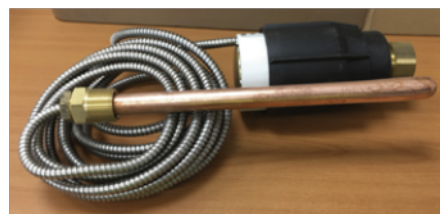
Termostato DANFOSS AIT-U 85/125 Apto para valvulas VIG2/VIS 2. Escala 85 a 125°C ,bulbo 225mm conexión 3/4"
