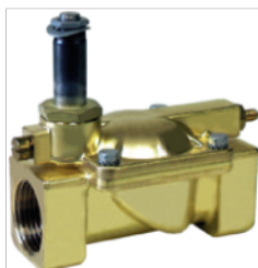
Cuerpo válvula de solenoide PARKER 7321BIN01 CM , rosca 3/8" normalmente cerrada, cuerpo de latón, cierre NBR, presión de trabajo: 0,1-20 bar , temperatura máxima 90 °C, con mando de apertura manual
