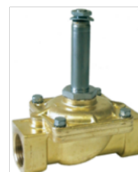
Cuerpo válvula de solenoide PARKER PM 126 YT, rosca 1/4" normalmente cerrada, cuerpo de latón, cierre teflón, presión de trabajo: 0-10 bar , temperatura máxima 140 °C.
