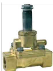
Cuerpo válvula de solenoide PARKER PM 143.2EN , rosca 1-1/4" normalmente abierta, cuerpo de latón, cierre NBR, presión de trabajo: 0,1-20 bar , temperatura máxima 90 °C.
