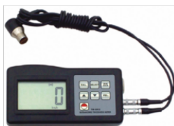
Detector de espesores ultrasónico SEI ME10
