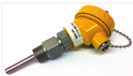
Sonda temperatura inmersión PT-100-3H 4-20 mA, longitud 50mm + vaina 1/2"M, 0 a 50°C
