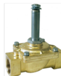
Cuerpo válvula de solenoide PARKER PM169 CN , rosca 3/4" normalmente abierta, cuerpo de latón, cierre NBR, presión de trabajo: 0,5-16 bar , temperatura máxima 90 °C.
