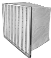
Filtro de aire MUNDOFAN FINEFIL ePM1 75% F8 592x287x360mm-6B marco 25mm
