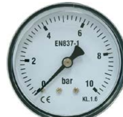
Manómetro metalico diámetro 50 mm posterior rosca 1/8" 0-10 bar S/D
