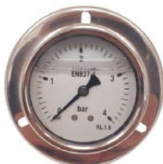
Manometro con glicerina diámetro 100 mm posterior con aro frontal rosca 1/2\" 0-4 bar S/D
