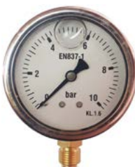
Manómetro con glicerina diámetro 63mm vertical rosca 1/4" 0-10 bar
