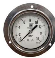
Manometro de acero inoxidable diámetro 63 mm posterior con aro frontal rosca 1/4\" 0-16 bar S/D
