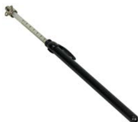
Termometro de cristal con funda metálica tipo boligrafo 0-100 °C * Funda metálica pintada negro * Alma de cristal * Fluido: alcohol * Clip de sujeción
