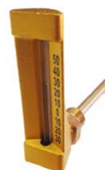
Termómetro capilla SEI angular caja 110x36mm inmersor 1/2"x100mm -30 a 50°C Materiales. - Caja: Aluminio anodizado dorado. - Vaina: Latón rosca 1/2" M. - Tubo: Cristal prismático. - Columna de líquido azul.
