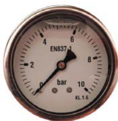
Manómetro de acero inoxidable con glicerina diámetro 100 mm posterior rosca 1/2" 0-10 bar S/D
