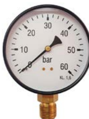
Manómetro diam. 100 mm. VERTICAL rosca 1/2\" 0-60 bar
