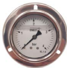
Manómetro de acero inoxidable con glicerina diámetro 100 mm posterior con aro frontal rosca 1/2" 0-4 bar S/D
