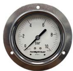
Manómetro diámetro 63 mm posterior con aro frontal rosca 1/4" 0-10 bar S/D
