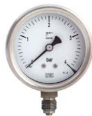
Manometro de acero inoxidable diámetro 100 mm vertical rosca 1/2\" 0-250 bar S/D
