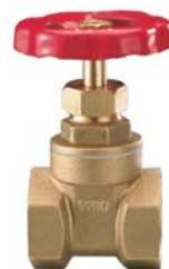
Valvula de compuerta de laton, cierre metal, PN16, rosca 1-1/2"
