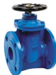
Válvula de compuerta de hierro fundido, cierre metal, PN16, con bridas DN-125
