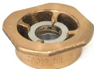
Válvula de retención de disco tipo wafer, cuerpo de latón, disco inox, cierre metal/metal DN-15
