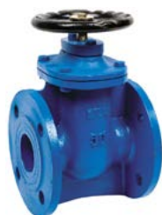
Válvula de compuerta de hierro fundido, cierre metal, PN16, con bridas DN-40
