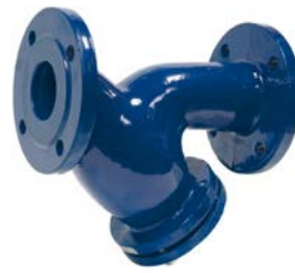
Filtro de hierro fundido, tamiz inox, PN16, c/bridas DN20
