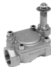
Válvula de solenoide cuerpo de acero inoxidable, membrana de viton, normalmente cerrada, con bobina 220 V rosca 3/4"
