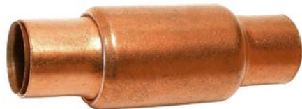
Compensador de dilatación para soldar a tubería de cobre de 15mm, carrera 6 mm
