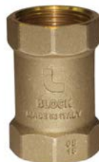
Válvula de retención de latón c/muelle, cierre por junta tórica de NBR, marca BLOCK, rosca 1/2"
