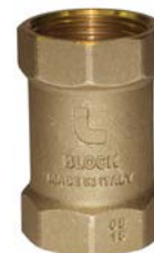
Válvula de retención de latón c/muelle, cierre por junta tórica de NBR, marca BLOCK, rosca 3/4"
